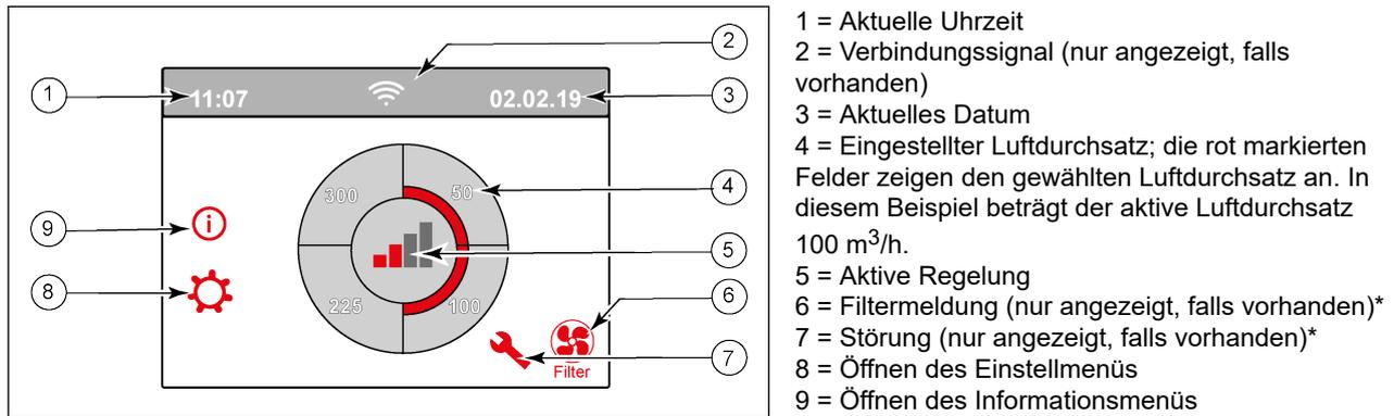
\* Filtermeldung und Störungsmeldung befinden sich an derselben Stelle im Display; die Störungsanzeige hat eine höhere Priorität und wird immer zuerst angezeigt, selbst wenn eine Filtermeldung aktiv ist!
