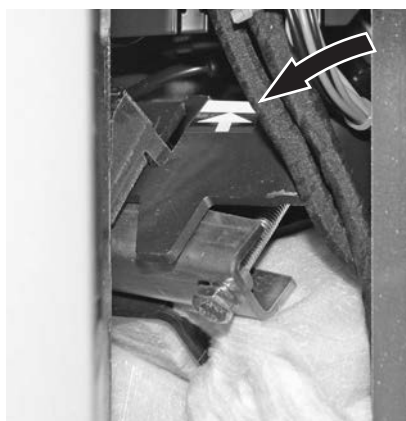
Fig. 12 Atornillar la fijación en la parte superior hasta el tope (marca)
