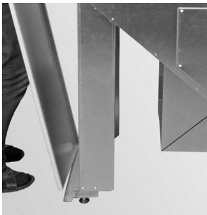
Fig. 36 Seitenwand links unten einhängen
