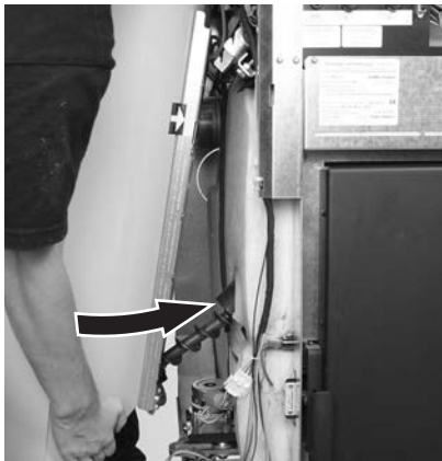
fig. 10 Faire passer la vis de transport dans le bas, au niveau du tube de vis sans fin
