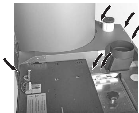
fig.33 Fixer le revêtement avec 6 vis à tête
