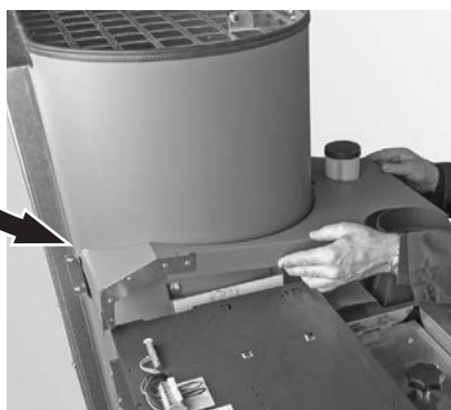
fig.32 Poser le revêtement avec précaution en haut à gauche
