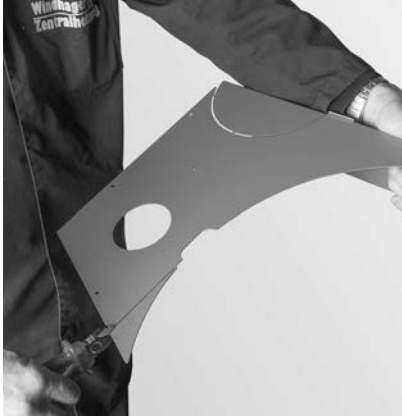
fig. 30 Staccare con le tenaglie l'angolo del rivestimento sinistro superiore
