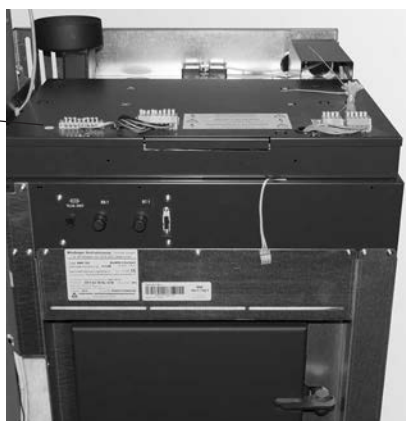
fig.24 Ouvrir le couvercle du tableau de distribution
