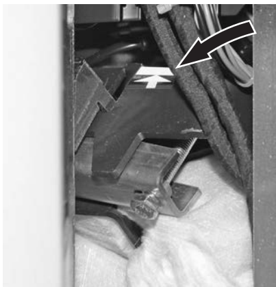
Fig. 12 Befestigung oben bis zum Anschlag (Markierung) festschrauben
