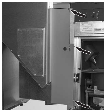
fig.35 Visser le revêtement à l'avant
