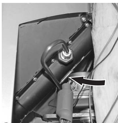
Fig. 15 Insertar del todo la sonda para el termostato de seguridad del tubo del tornillo sinfín
