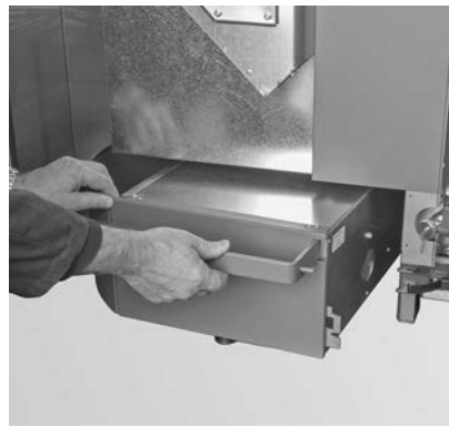
fig. 41 Inserire il cassetto raccoglicenere spingendolo leggermente inclinato e introdurre completamente la maniglia nel cassetto
