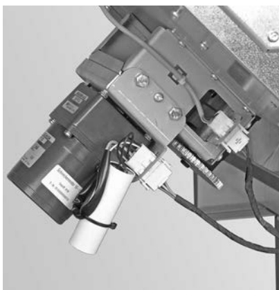
Fig.19 Stecker von Schneckenmotor und von Näherungsschalter anstecken
