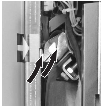
fig. 11 Accrocher le compartiment hebdomadaire au niveau des 2 repères
