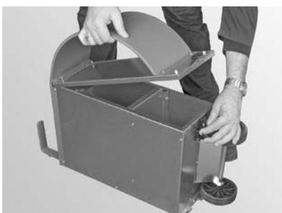
Fig. 34 Spannbügelverschlüsse öffnen, Deckel abnehmen und Aschebox entleeren
