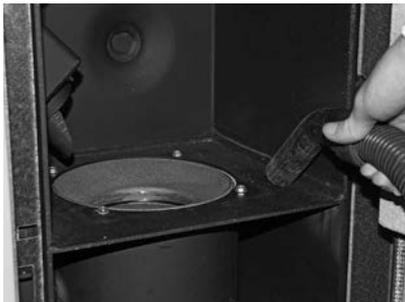
Fig. 38 Verbrennungsrückstände aus dem Brennraum entfernen
