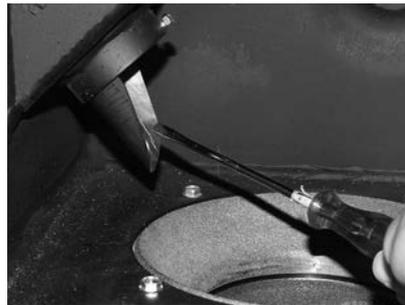
Fig. 37 Fallrinne reinigen
