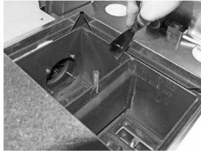
Fig. 56 Nachheizflächen reinigen
