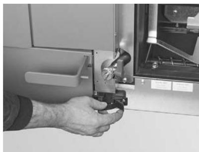
Fig. 31 Spannbügelverschluss öffnen
