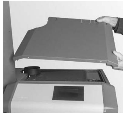
Fig. 61 Abdeckung oben abheben
