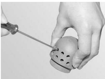
Fig. 45 Primärluftdorn vorsichtig reinigen
