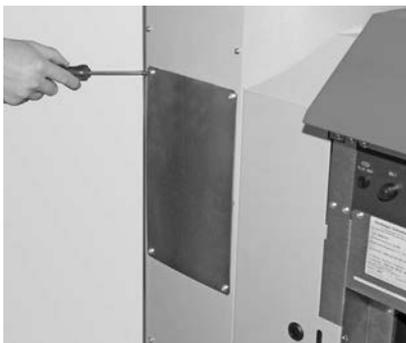
Fig. 65 Schrauben entfernen,
