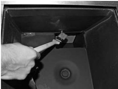
Fig. 36 Thermocontrol-Fühler reinigen
