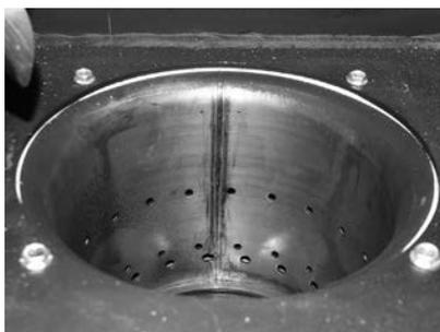
Fig. 46 Sekundärluftlöcher im Brennertopf reinigen
