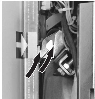
Fig. 34 Vorratsbehälter bei Markierung 2 x einhängen
