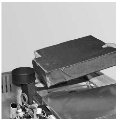
Fig. 23 Isolierung entfernen
