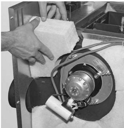
Fig. 31 Isolierung (beiliegend, seitlich unter Abgasgebläse) anbringen
