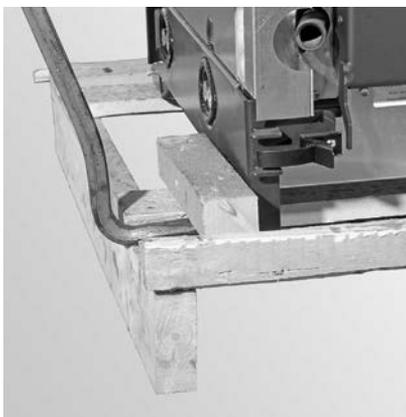
Fig. 9 seitliches Bodenholz entfernen
