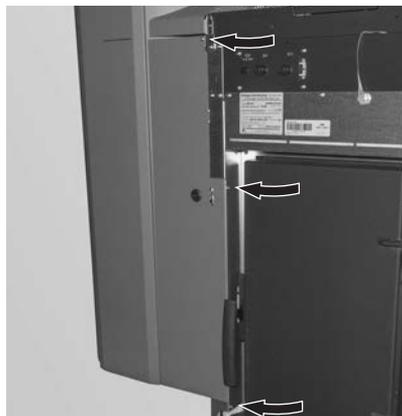
Fig. 55 Verkleidung vorne anschrauben
