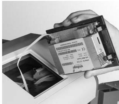
Fig. 65 Anschlusskabel InfoWIN Touch anstecken und InfoWIN Touch in Bedienfeld stecken (mit Stecker nach oben)
