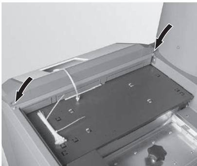
Fig. 87 4 Schrauben bei Bedienfeld lösen
