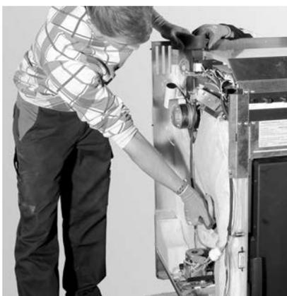
Fig. 11 Griffposition bei Schneckenrohr und Abgasstutzen
