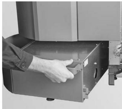
Fig. 70 Aschebox leicht schräg einschieben und Griff bei Aschebox ganz hineinschieben
