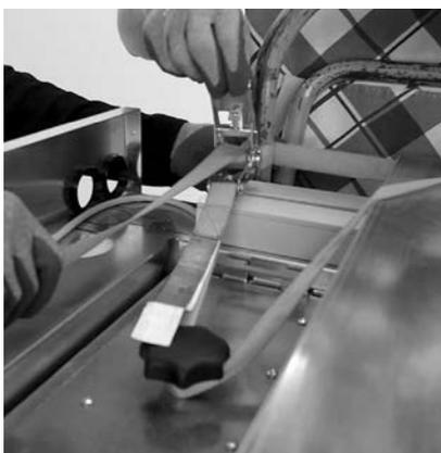
Fig. 13 Kessel mit Spanngurt an Rodel befestigen
