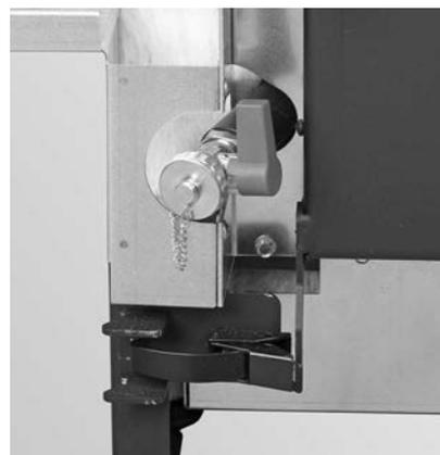
Fig. 22 Füll- und Entleerhahn eindrehen (Griffposition rechts) und Griff wieder aufstecken
