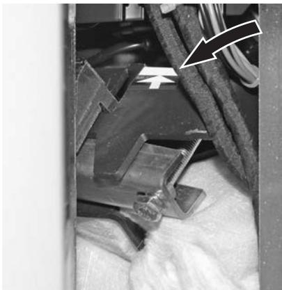
Fig. 35 Befestigung oben bis zum Anschlag (Markierung) festschrauben
