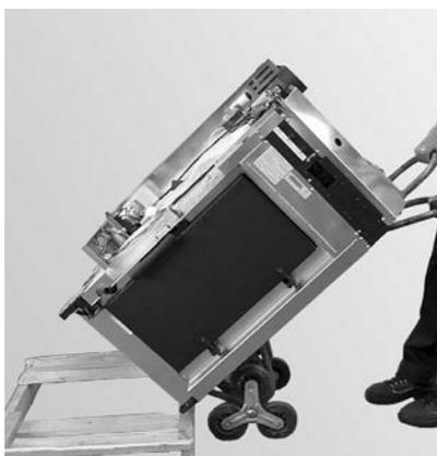
Fig. 14 Kessel mit Rodel von Palette heben
