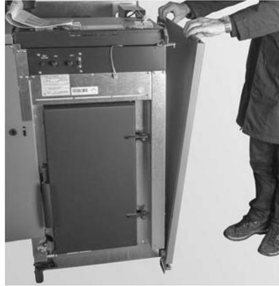
Fig. 60 Seitenwand einhängen
