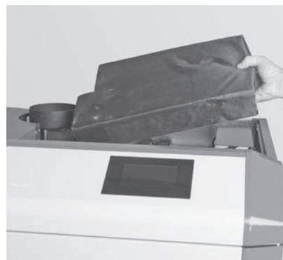
Fig. 99 Isolierung auflegen
