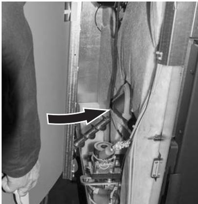
Fig. 33 Förderschnecke unten bei Schneckenrohr einfädeln
