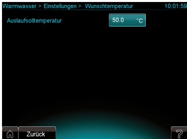
Abb. 6.2 Anzeige Wunschttemperatur Warmwasser einstellen
