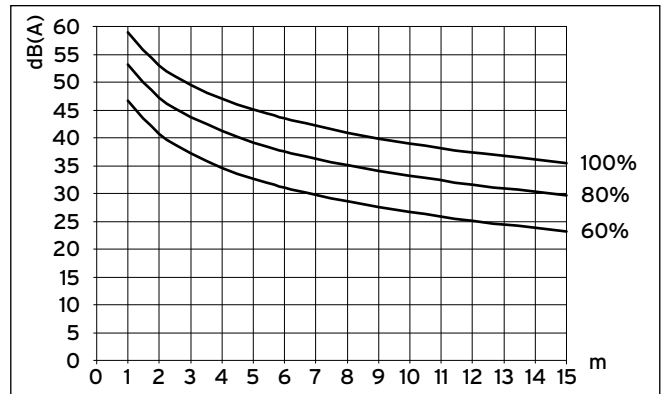
Abb. 6.5 Schalldruckpegel zweier Außeneinheiten in dB(A) in Abhängigkeit von der Entfernung und der Lüfterdrehzahl für VWL 171/3 S bei Freifeldaufstellung
