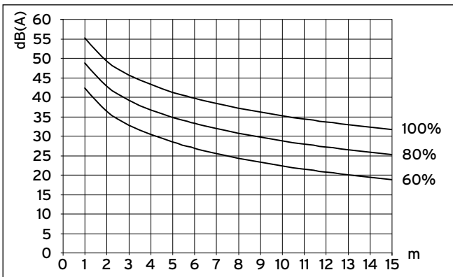
Abb. 6.4 Schalldruckpegel zweier Außeneinheiten in dB(A) in Abhängigkeit von der Entfernung und der Lüfterdrehzahl für VWL 141/3 S bei Freifeldaufstellung
