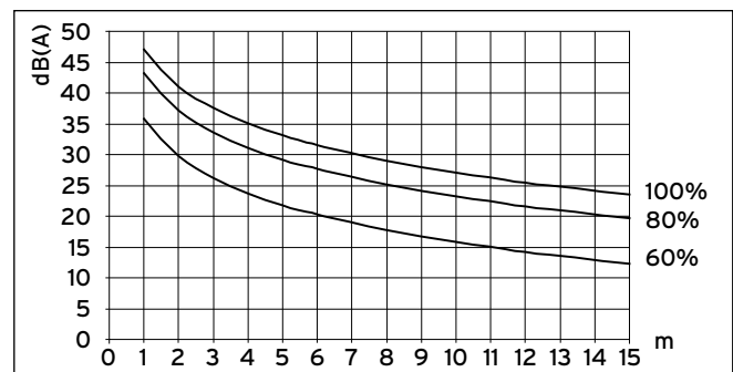
Abb. 6.1 Schalldruckpegel einer Außeneinheit in dB(A) in Abhängigkeit von der Entfernung und der Lüfterdrehzahl für VWL 61/3 S bei Freifeldaufstellung
