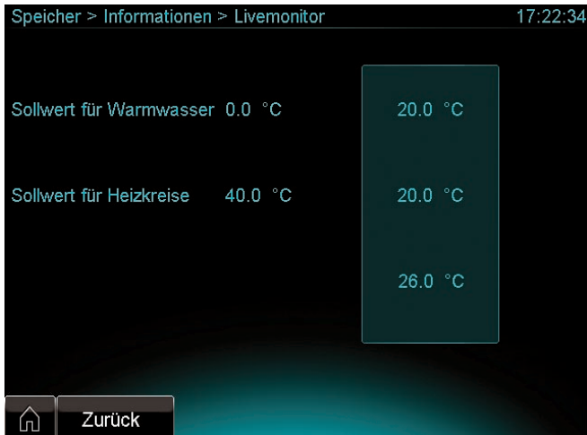
7.7 Anzeige Anlagenübersicht Pufferspeicher
