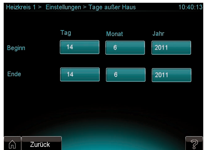
6.5 Anzeige Tage außer Haus (hier Heizkreis 1)
