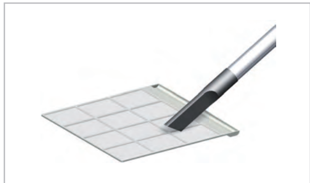
Abb. 51: Reinigung mit dem Staubsauger
