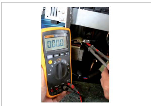
Abb. 46: Messung des Transformators
