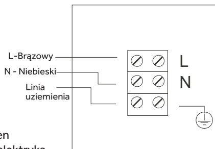
Zaciski przewodów pompy ciepła
