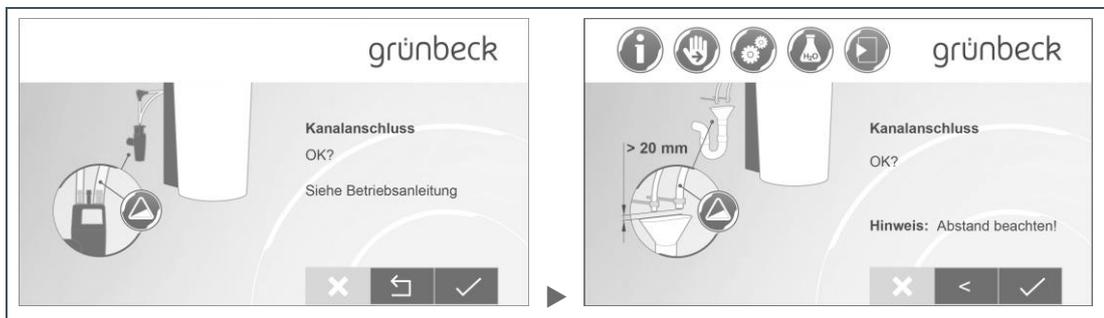
3. Prüfen Sie, ob die Leitungen zum Kanalanschluss mit Gefälle verlegt wurden.
