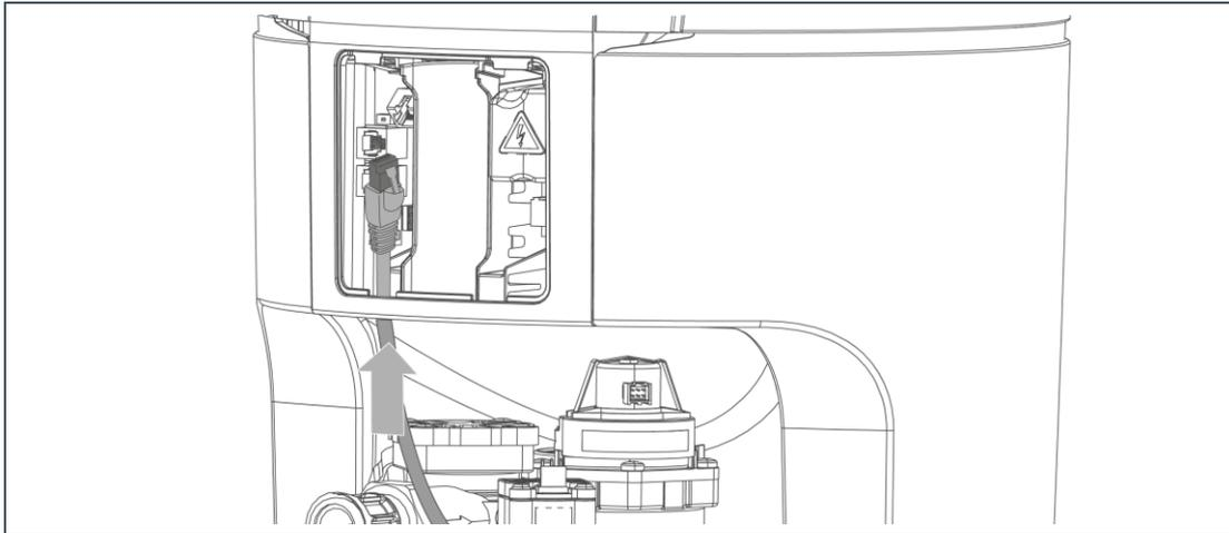
4. Führen Sie das Ethernet-Patchkabel von unten zur Schnittstellenplatine Daten.
