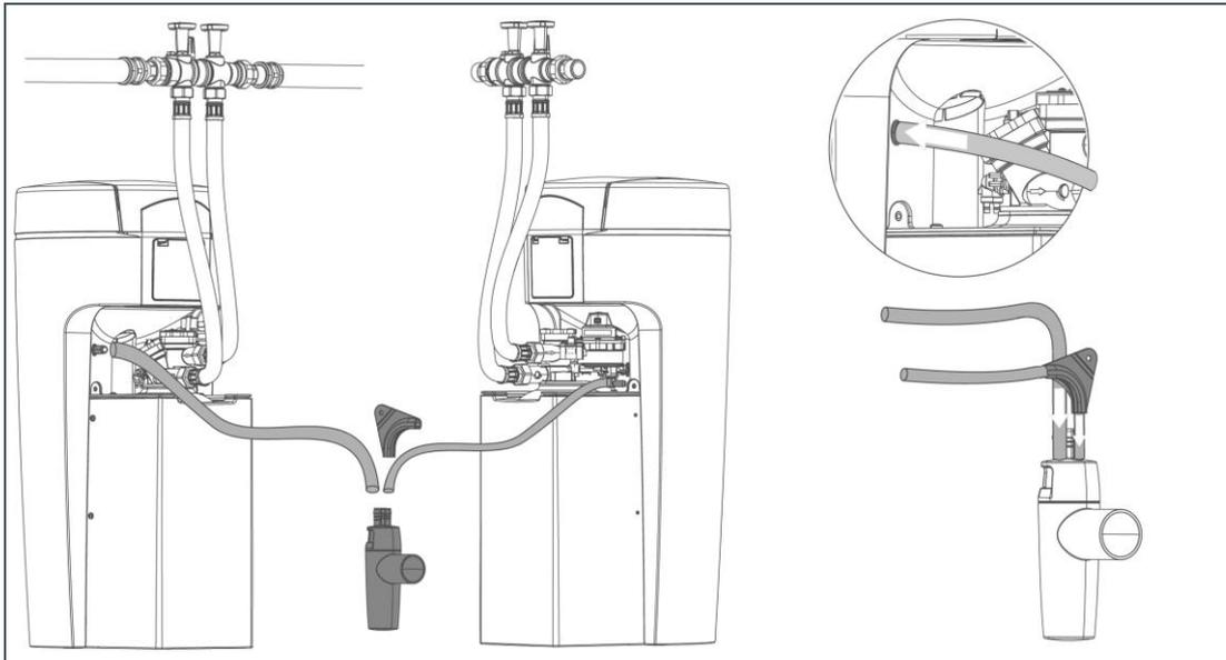
1. Kürzen Sie den Spülwasserschlauch (Ø 12 mm) auf die benötigte Länge.
