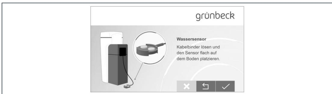
4. Platzieren Sie den Wassersensor flach auf dem Boden.
