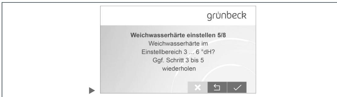
18. Stellen Sie die Weichwasserhärte mittels Verschneideventil ein.
