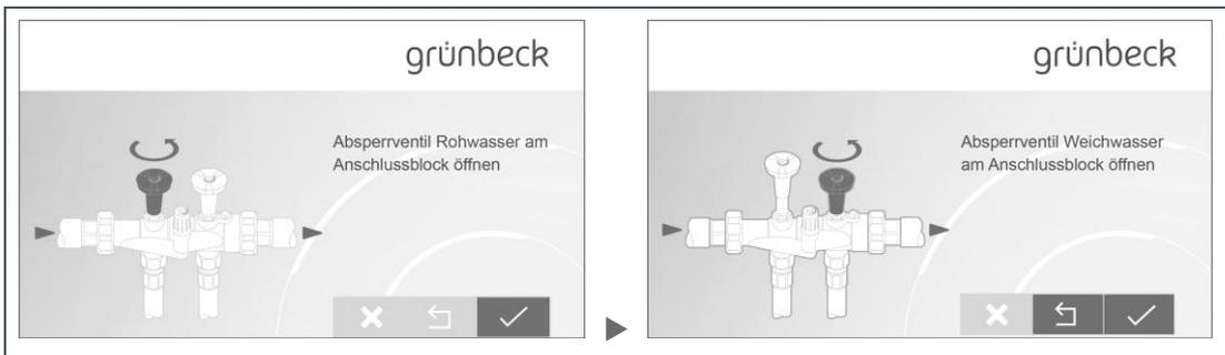
9. Öffnen Sie das Absperrventil Rohwasser.
