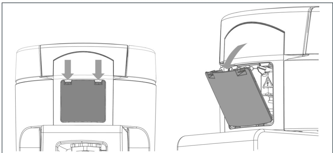
3. Öffnen Sie die Abdeckung an der Rückseite.
