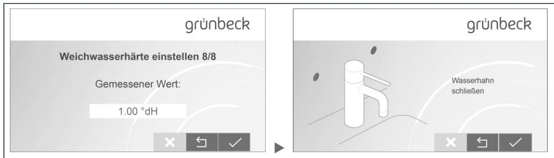
21. Tippen Sie die eingestellte Weichwasserhärte am Display ein.
