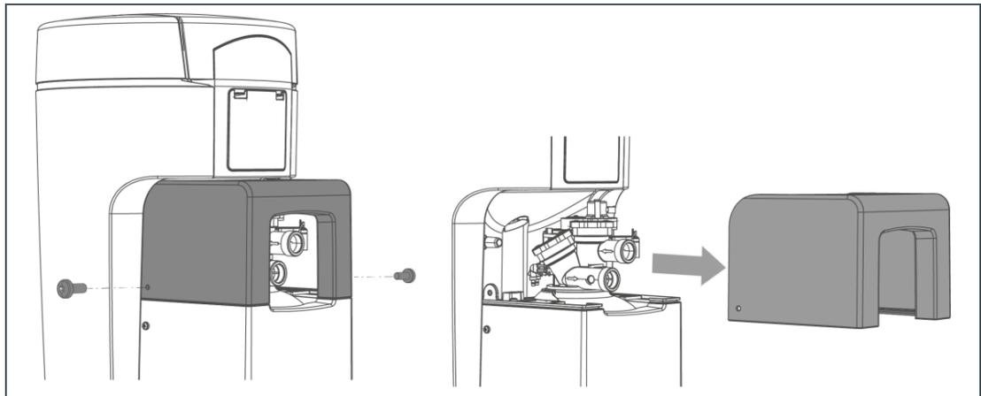
1. Lösen Sie beide seitlichen Schrauben am Oberteil Technikgehäuse.
