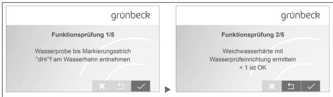
12. Entnehmen Sie kaltes Wasser an der Wasserentnahmestelle.
