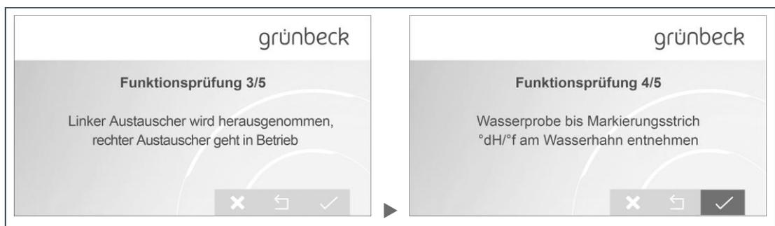
14. Entnehmen Sie kaltes Wasser an der Wasserentnahmestelle.
