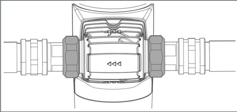
6. Installieren Sie den Filter spannungsfrei und ziehen Sie die Überwurfmuttern fest an.
