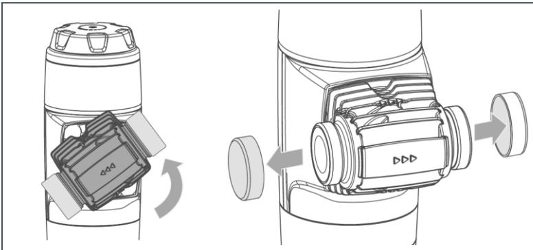
4. Drehen Sie den Klick-Anschlussflansch in die zu Ihrer Durchflussrichtung passenden Position (Kennzeichnung auf Klick-Anschlussflansch).
