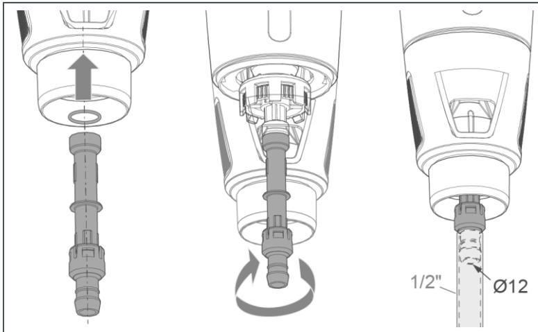
1. Montieren Sie den Schlauchadapter.
