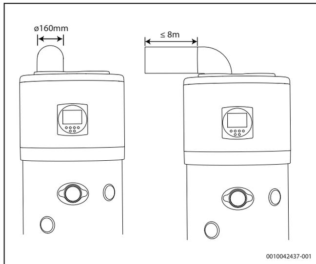
Bild 10 Einfache Luftleitung
