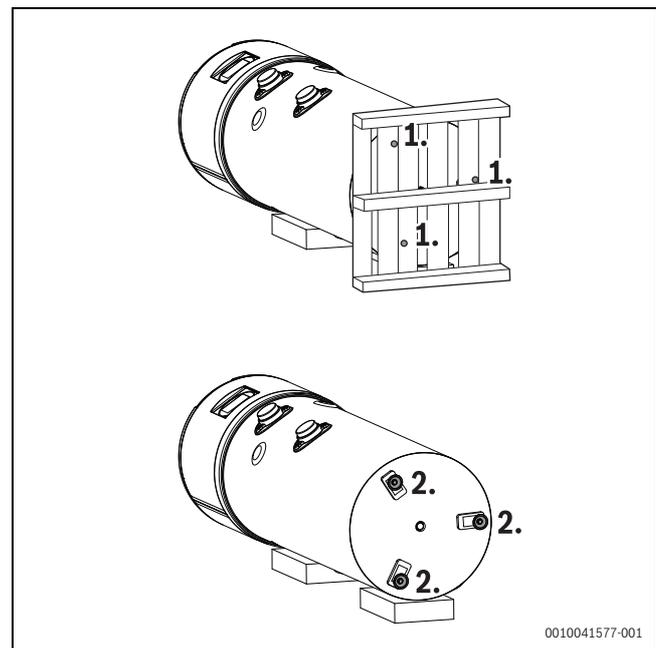
Bild 6 Entfernen der Palette und Montage der Stellfüße
