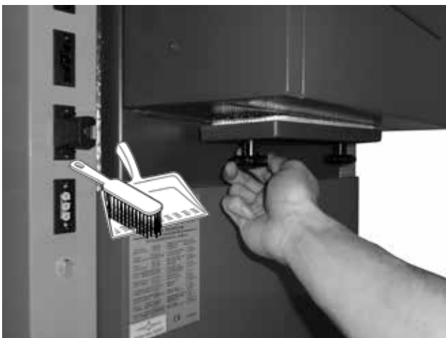
Veranschaulichung der Reinigung des Rauhabzuges im hinteren Bereich des Kessels.
