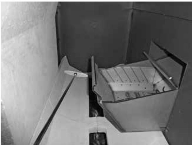
Herunterschütten der Asche in den unteren Raum (Aschenkasten)
