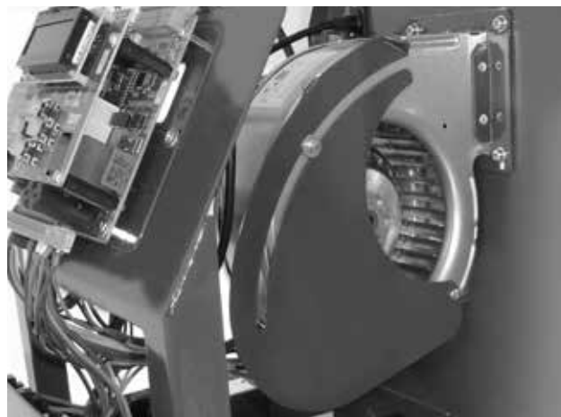
Brennerventilator mit der Luftklappe. Durch Öffnen der Luftklappe wird die Flammenlänge verkürzt.
