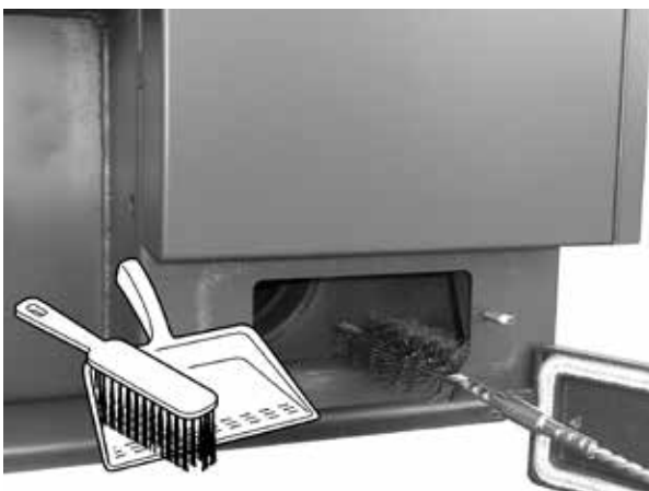
Muster – die Reinigung des Rauchkanals – unterer Deckel
