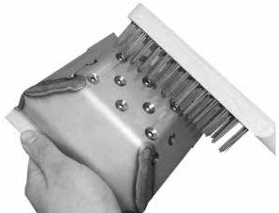
Beispiel: Reinigung der Brennkammer
