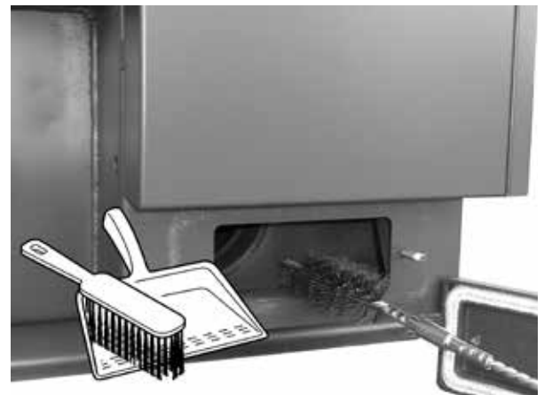
Muster – die Reinigung des Rauchkanals – unterer Deckel
