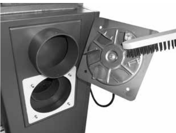
Muster – die Reinigung des Umlaufrades und die Kontrolle der Schaufel bei Saugzuventilator
