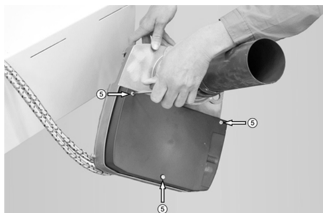
Fig. 2: Smontaggio del silenziatore di aspirazione
