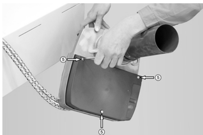
Fig. 2: Démontage du silencieux d'admission
