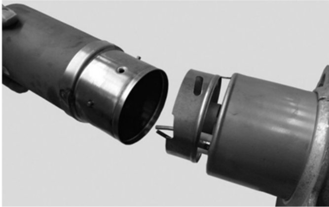
Abb. 3: Montage Keramikrohr auf Stützrohr
