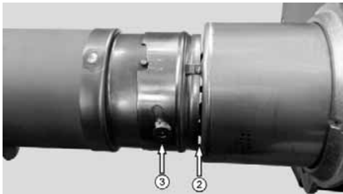
Abb. 4: Einstellung Rezirkulationsmaß R ② (Abbildung beispielhaft)
