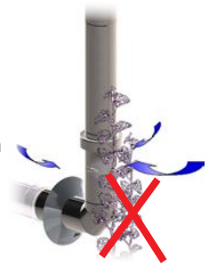
Abb. 11: Verbrennungsluft-Ansaugung frei halten
