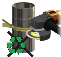
Abb. 5: Außenrohr kürzen und entgraten
