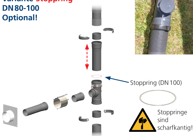
Abb. 8: Beispiel T-Stück mit Fixschellen sichern, DN 100 mit Stoppring
