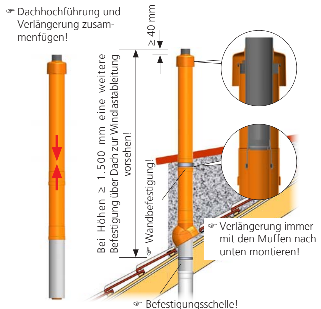
Abb. 5 Dachhochführung fertig verlängert
