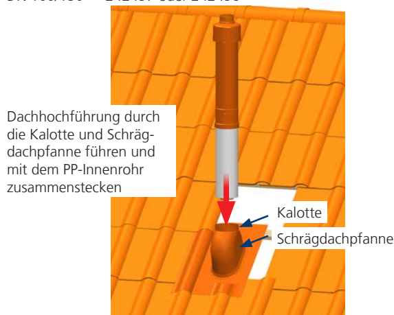
Abb. 37: Dachhochführung bei PolyCase DN 60 bis 100
