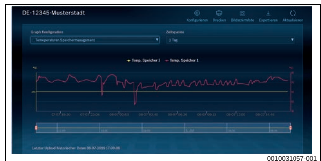
Bild 100 Control Center CommercialPLUS: Graph; Anzeige der aufgezeichneten Datenpunkte. Max. Speicherdauer: 2 Jahre, Auflösung: 1°-Schritte; bis zu max. 125 Datenpunkte
