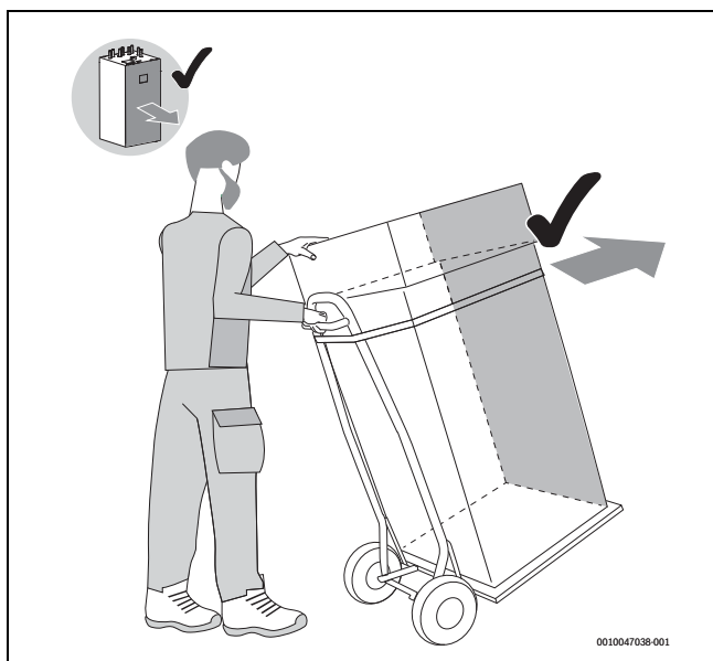
Bild 9 Inneneinheit mit einer Sackkarre transportieren
