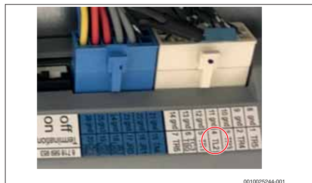
Bild 12 Referenzfühler TL2 an der I/O-Modul-Platine
