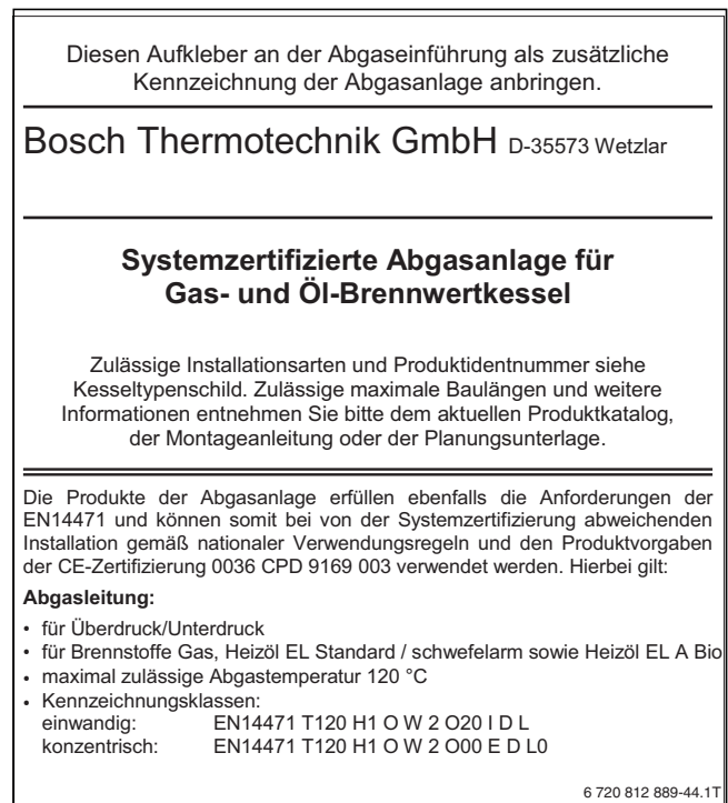
Bild 128 Kennzeichnungsaufkleber zur Systemzertifizierung
