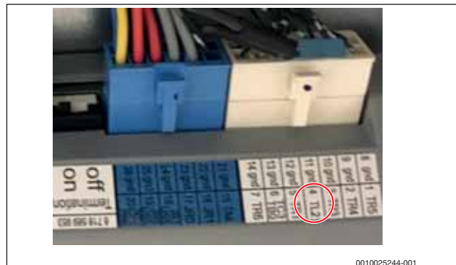
Bild 10 Referenzfühler TL2 an der I/O-Modul-Platine
